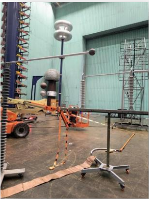
Ensaio de possíveis sensores para captura de energia de campo elétrico
