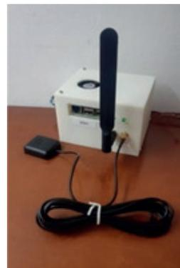
Figura 2 - Protótipo de datalogger que será integrado em prova de conceito de análise de dados por IA<sup>2</sup>
