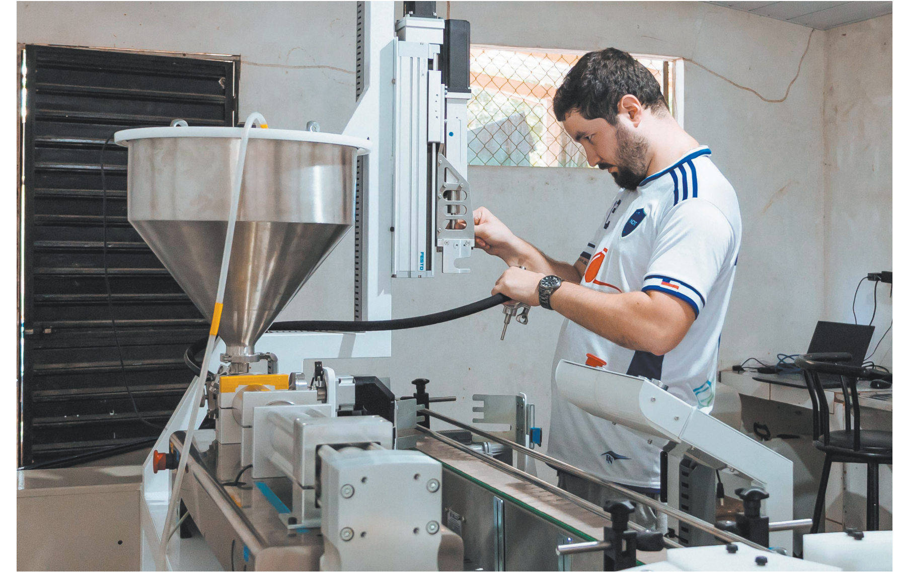
Máquina de fácil manuseio e manutenção, desenvolvida para envasar toda a produção e atender a volumes diversos, reduziu o tempo do processo, aumentando o valor de mercado do produto final
